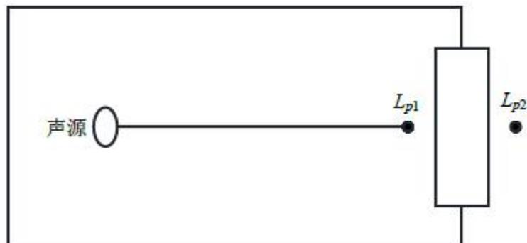
计算某一室内声源靠近围护结构处产生的倍频带声压级:
